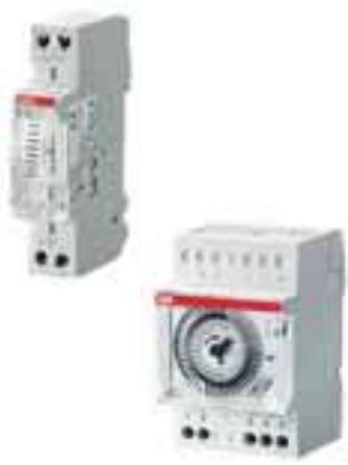
Эти реле используются для размыкания и замыкания цепи согласно заданной программе. Реле имеют функцию постоянного включения или отключения. Имеются исполнения с суточным и недельным циклом программирования. Приборы ATS-1R и ATS-7R снабжены встроенным аккумулятором, который заряжается от электросети и обеспечивает сохранность программы при длительном (до 150 ч) отключении электропитания.
